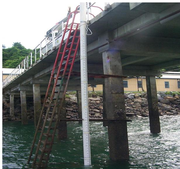
Fig. 2. Estación de marea Sutron , codificador Digital más transducer de presión y la Regla de marea utilizado en las campañas Hidrográficas.
